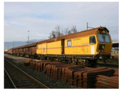
Train meuleur de rails (Scheuchzer S.A.)
